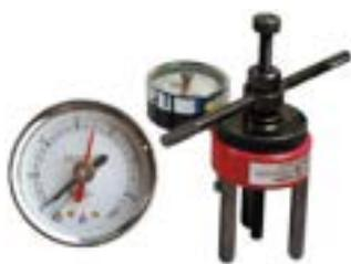
Pour vérifier facilement la résistance des boulons d'ancrage post-installés sur site, nous avons conçu et développé la série AT de machines d'essais non destructifs, qui peuvent s'adapter à divers tests requis pour l'installation d'équipements, la résistance aux tremblements de terre, les travaux de génie civil ou d'autres applications.
